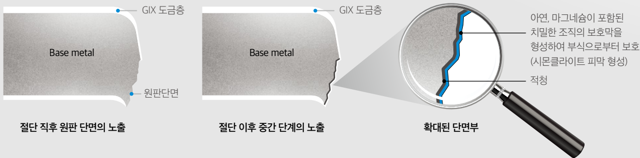
절단면 부식 방지 메커니즘 (Self-sealing Active Mechanism)
